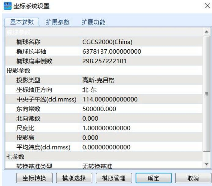
椭球：应根据施工的坐标系选择椭球，一般所使用椭球为 WGS84 椭球、北京 54 椭球、西安 80 椭球和 CGCS2000 椭球。
