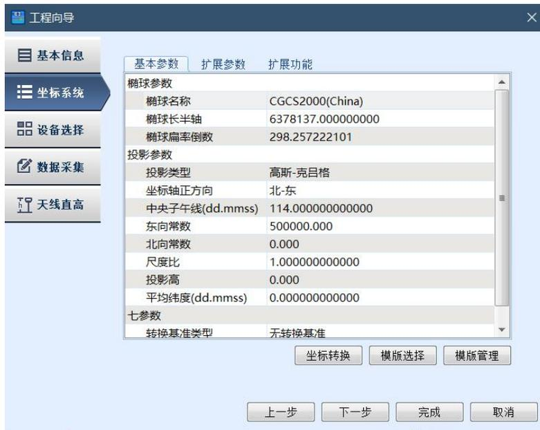
【扩展参数】中可以将求得的转换参数填入，设置完【坐标投影参数】以后，点击左下角的【扩展参数】按钮，进入转换参数输入界面，然后根据实际工程作业的需要，可以使用七参数、四参数和校正参数以及高程拟合参数、垂直平差参数和水准参数，在输入所用的参数后，应先选中相应的参数使用复选框。
