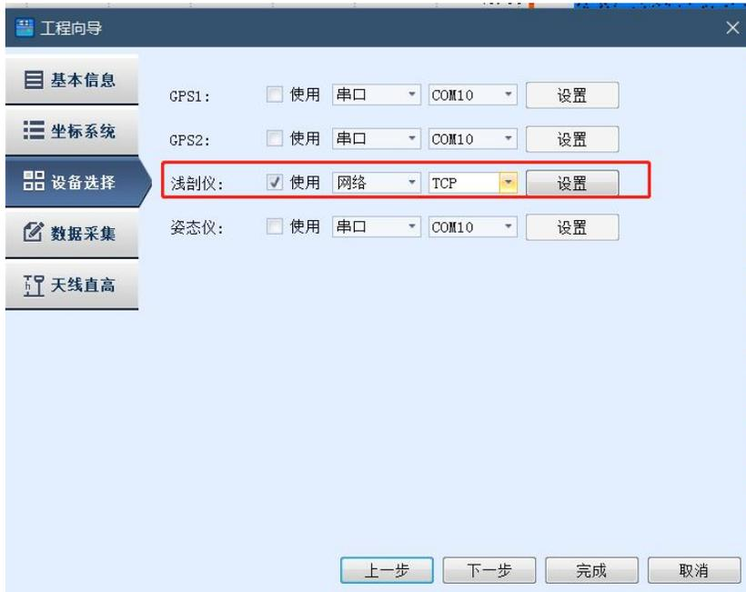
点击【设置】，在【端口设置】中，【IP】设为 127.0.0.1，【端口号】为 12358；点击【确定】
