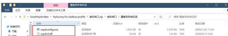
打开【Configure Virtual Serial Port Driver】软件，添加一组虚拟端口，图中添加了 COM8 与 COM15，则表明 COM8 与 COM15 联通，浅剖控制软件的数据可以通过 COM8 口发送出去
