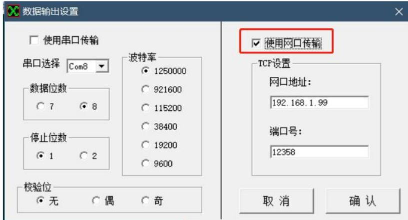
打开【浅剖测量】软件，在工程向导中勾选浅剖仪，选择【网络】、【TCP】
