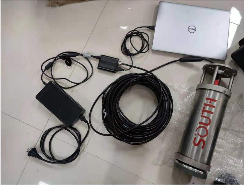
将 RTK、串口线、串口转 USB 线按以下方式跟电脑连接
