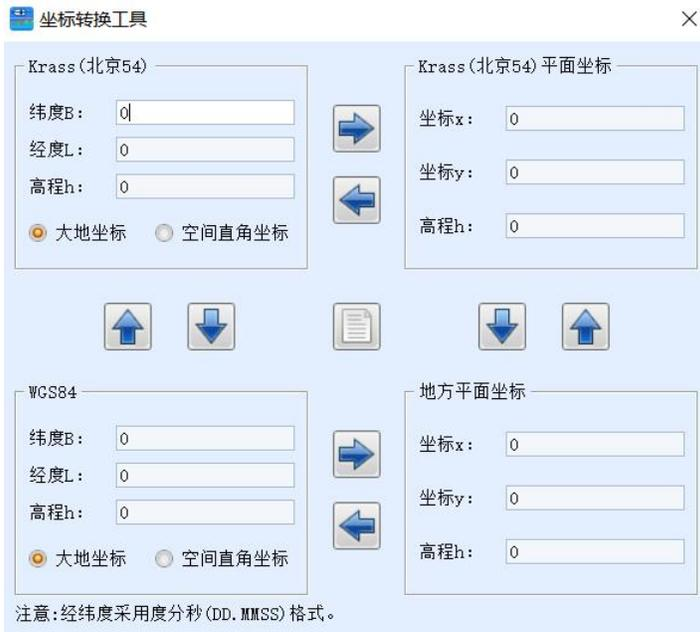
坐标转换工具可以完成北京-54 椭球、西安-80 椭球等常用椭球和 WGS84 椭球的大地坐标、空间直角坐标、平面坐标之间的转换。只要输入坐标，然后点击上下左右提示箭头，就可以进行转换。如果要将北京-54 的大地坐标转换成北京-54 的空间直角坐标，那么先选择【大地坐标】然后输入大地坐标，最后选择【空间直角坐标】，这样就完成转换了。
