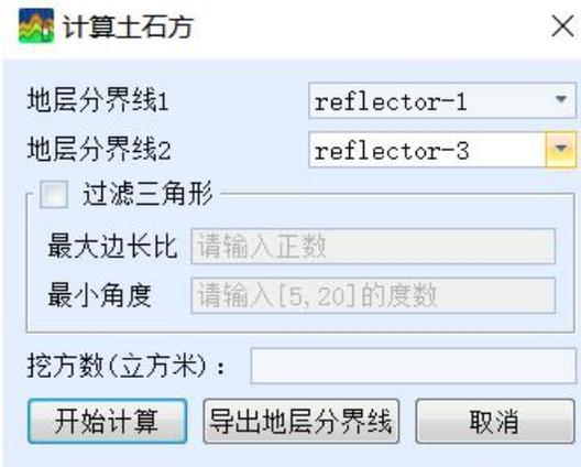
并且在该界面，可以【导出地层分界线】，导出格式为.dat，数据依次为点号、北坐标、东坐标、高程
